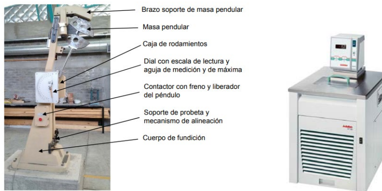
Figura N°1: Máquina para ensayo de impacto y Criotermostato para variar la temperatura de probetas
