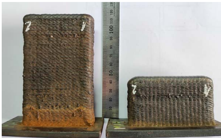
Figura 3: Paredes obtenidas por WAAM de 110 y 50 mm de altura
