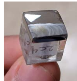
Figura 2. Muestra con el ataque luego de los ciclos PPT.
